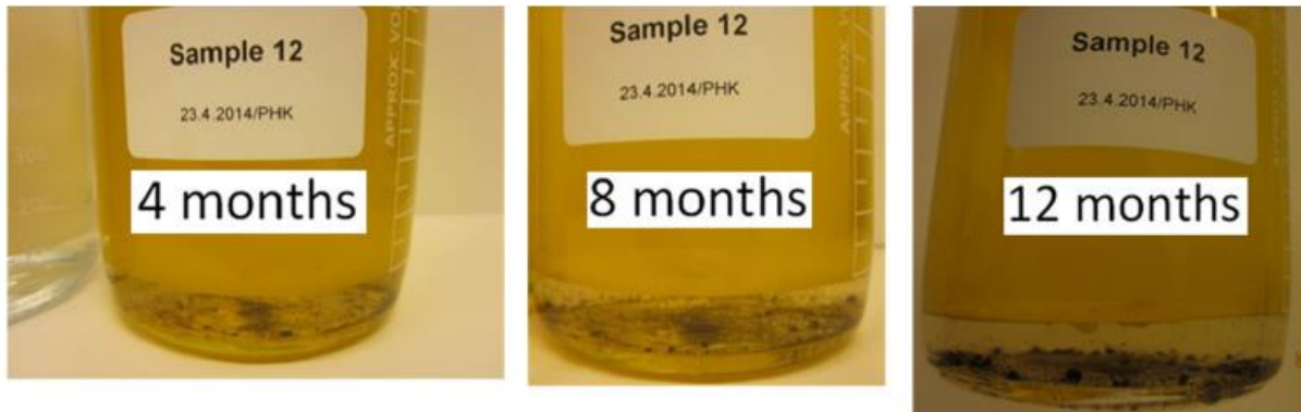
Kuva 3-15: Säilyvyyskokeet: vesifaasin (10% vettä) vaikutus polttoainenäytteeseen (Näyte: perinteisen biodieselin 20% -seos), havaittava mikrobikasvusto vesifaasissa .
