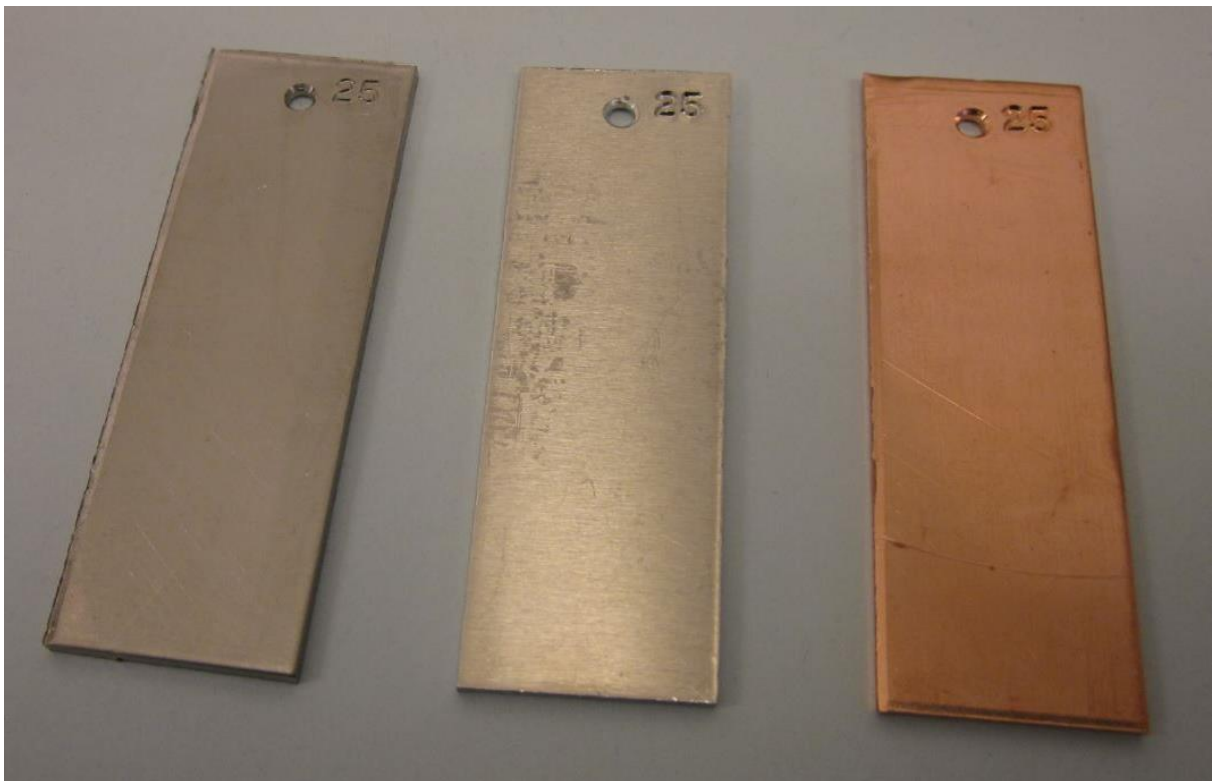
Kuva 3-12: Materiaalitesteissä käytettyjä metallilevyjä (vasemmalta: ruostumaton teräs, alumiini ja kupari)
