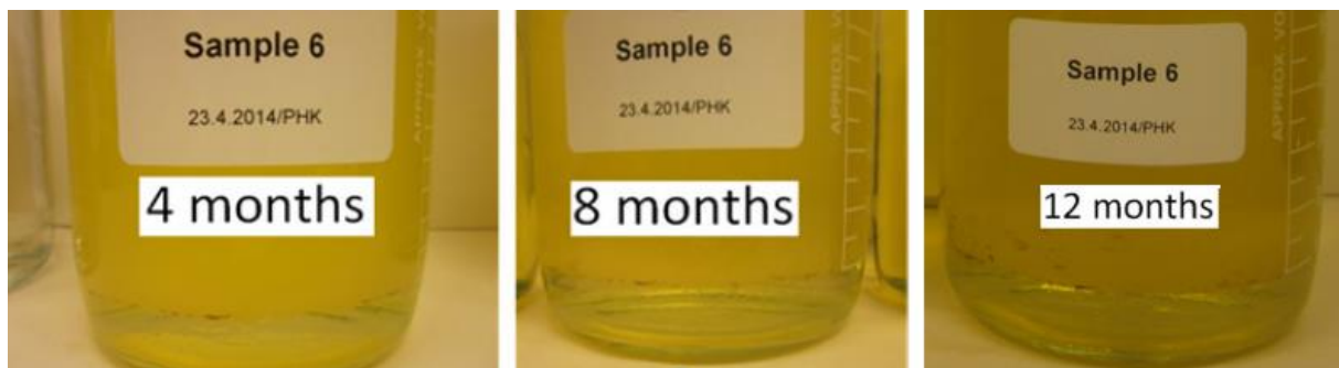
Kuva 3-16: Säilyvyyskokeet: vesifaasin (10% vettä) vaikutus polttoainenäytteeseen (Näyte: UPM BioVerno 20% -seos), puhdas vesifaasi .
