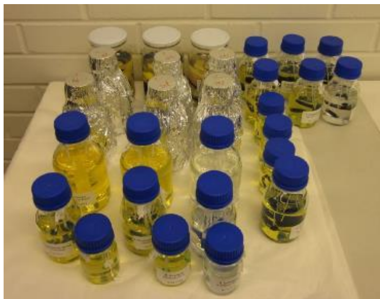
Kuva 3-10: Materiaalitesti – materiaalit upotettuina polttoainenäytteisiin.
